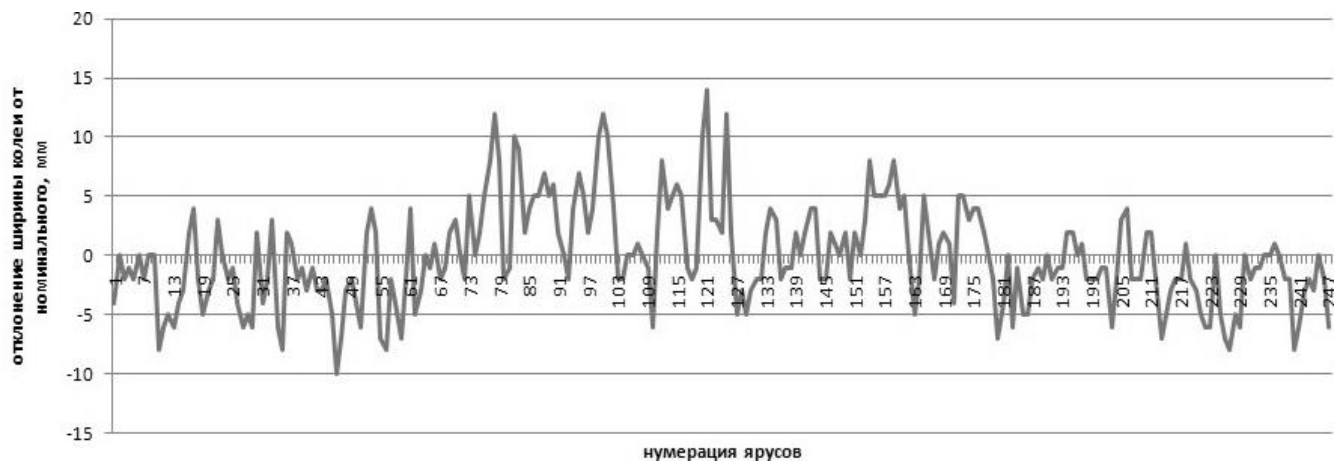
Рисунок 3 - Отклонение ширины колеи по глубине ствола
